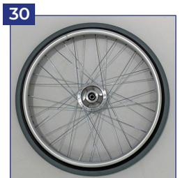
30 Antriebsrad HOGGI light mit Trommelbremse
