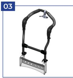
03 Schiebebügel, abnehmbar
