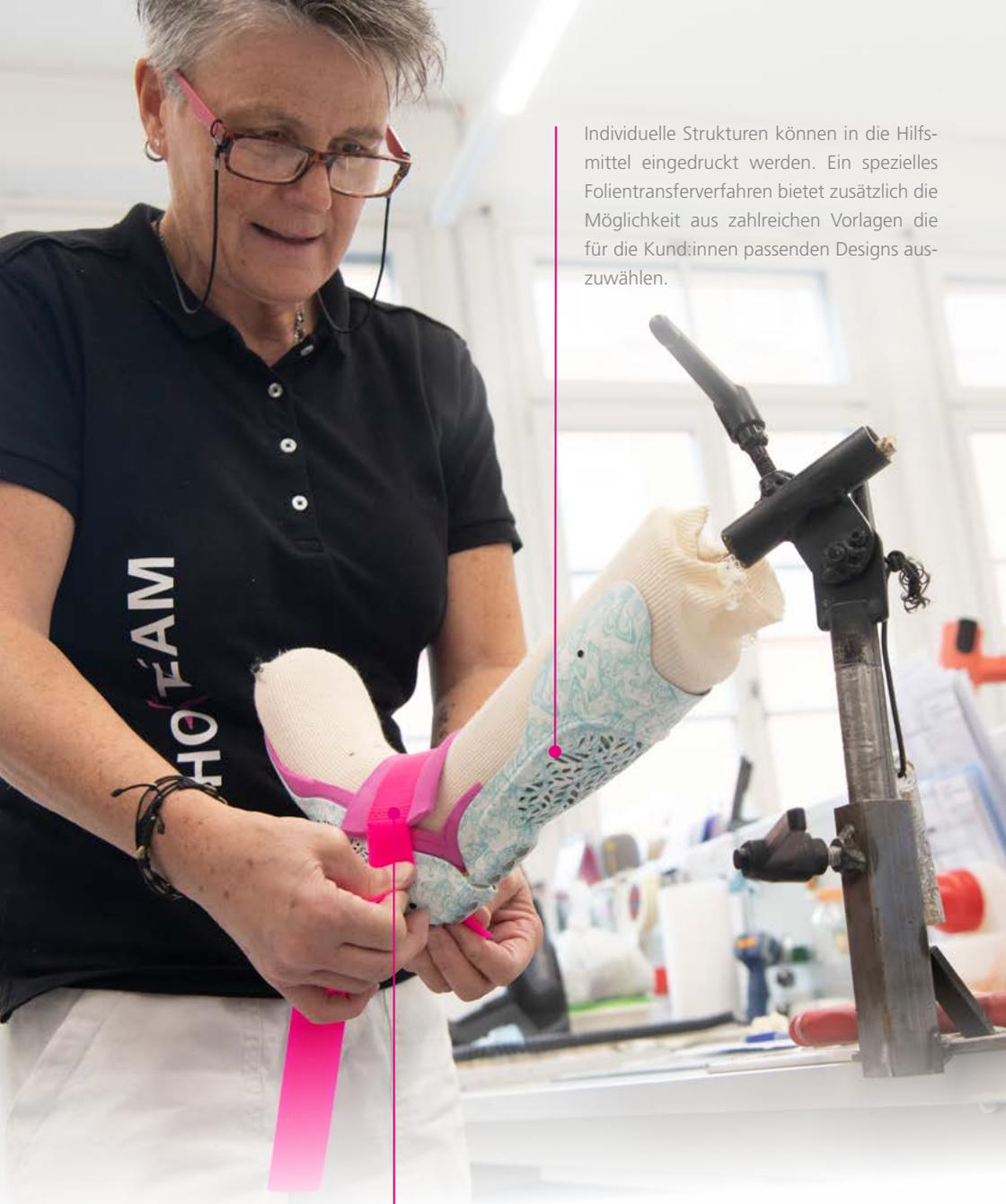
Individuelle Strukturen können in die Hilfsmittel eingedruckt werden. Ein spezielles Folientransferverfahren bietet zusätzlich die Möglichkeit aus zahlreichen Vorlagen die für die Kund:innen passenden Designs auszuwählen.
