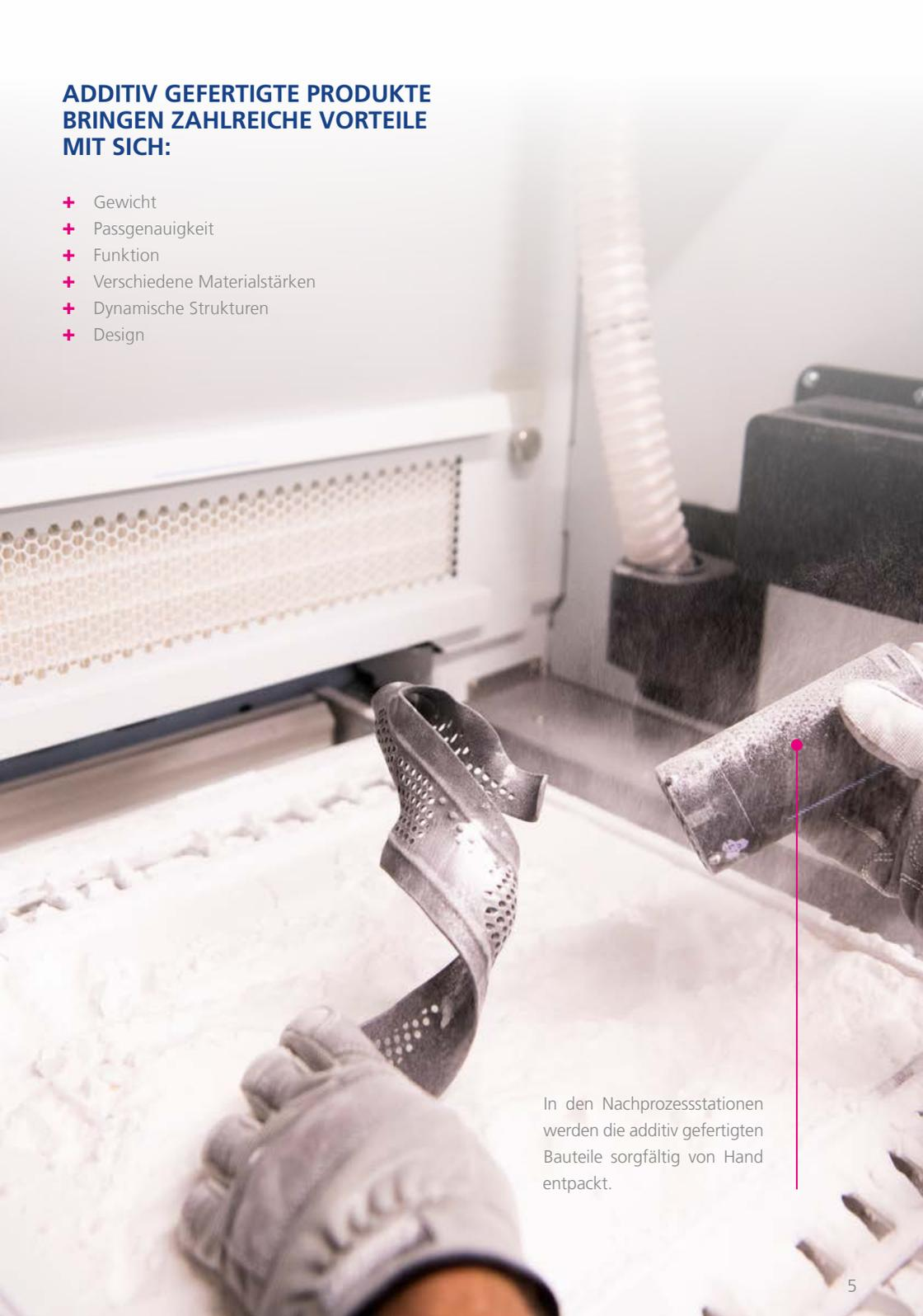
In den Nachprozessstationen werden die additiv gefertigten Bauteile sorgfältig von Hand entpackt.
